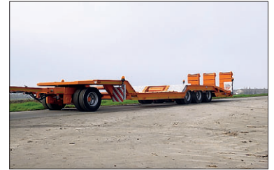
De nieuwe dieplader van Dezeure, die speciaal ontwikkeld is voor het vervoer van zelfrijdende oogstmachines.
