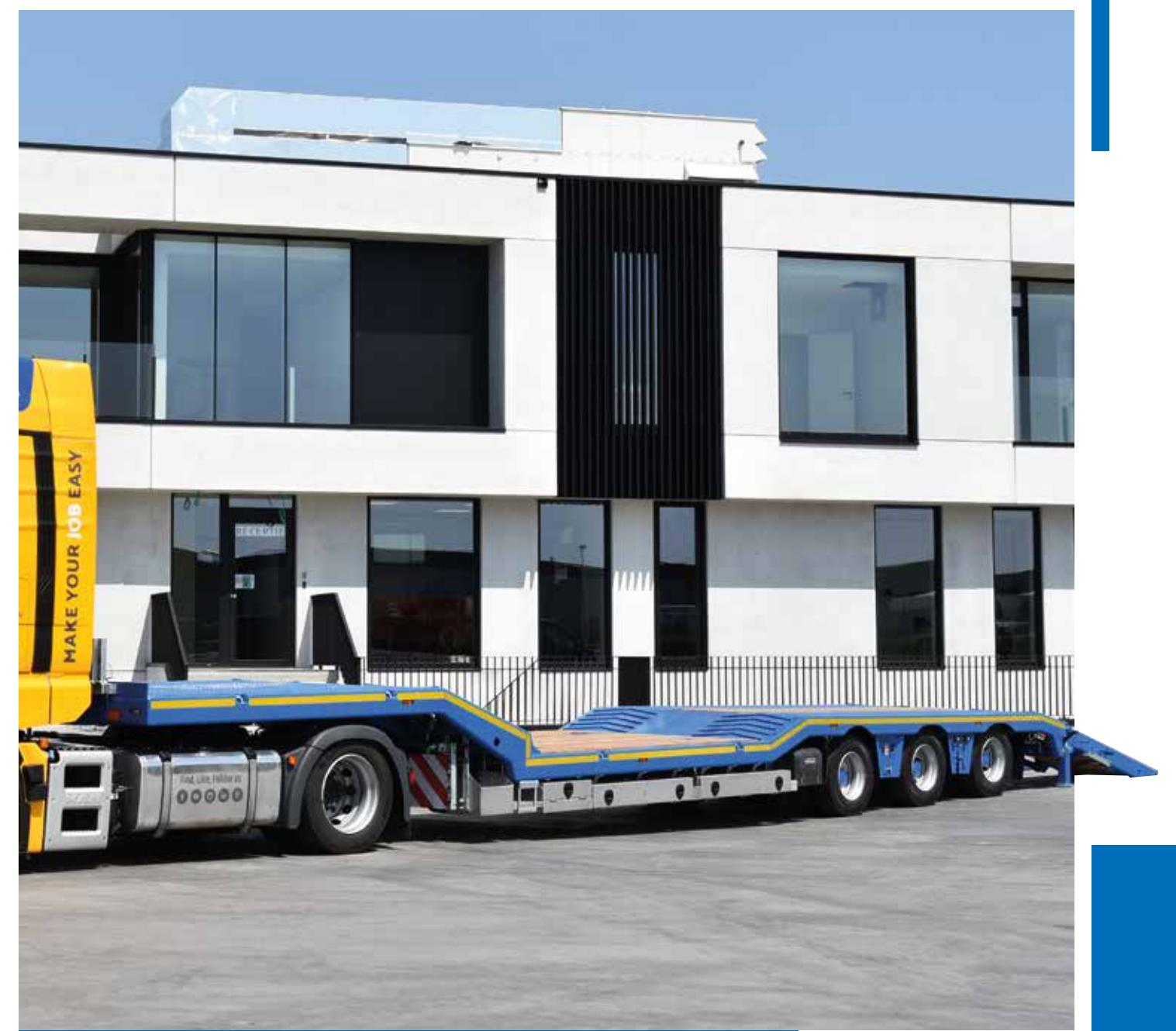
Deze diepladers worden vervaardigd uit profielen van **hoogwaardig staal**. Deze profielen in combinatie met **voorspanning** zorgen voor een **lager leeggewicht** zonder te hoeven inboeten in **duurzaamheid en draagvermogen**. Doordat we de profielen zelf vervaardigen kunnen we de **ideale afmetingen** naar wens van de klant aanbieden. De uitgebreide optie mogelijkheden zorgen voor een heel ruim toepassingsgebied van de DEZEURE SRD opleggers.
