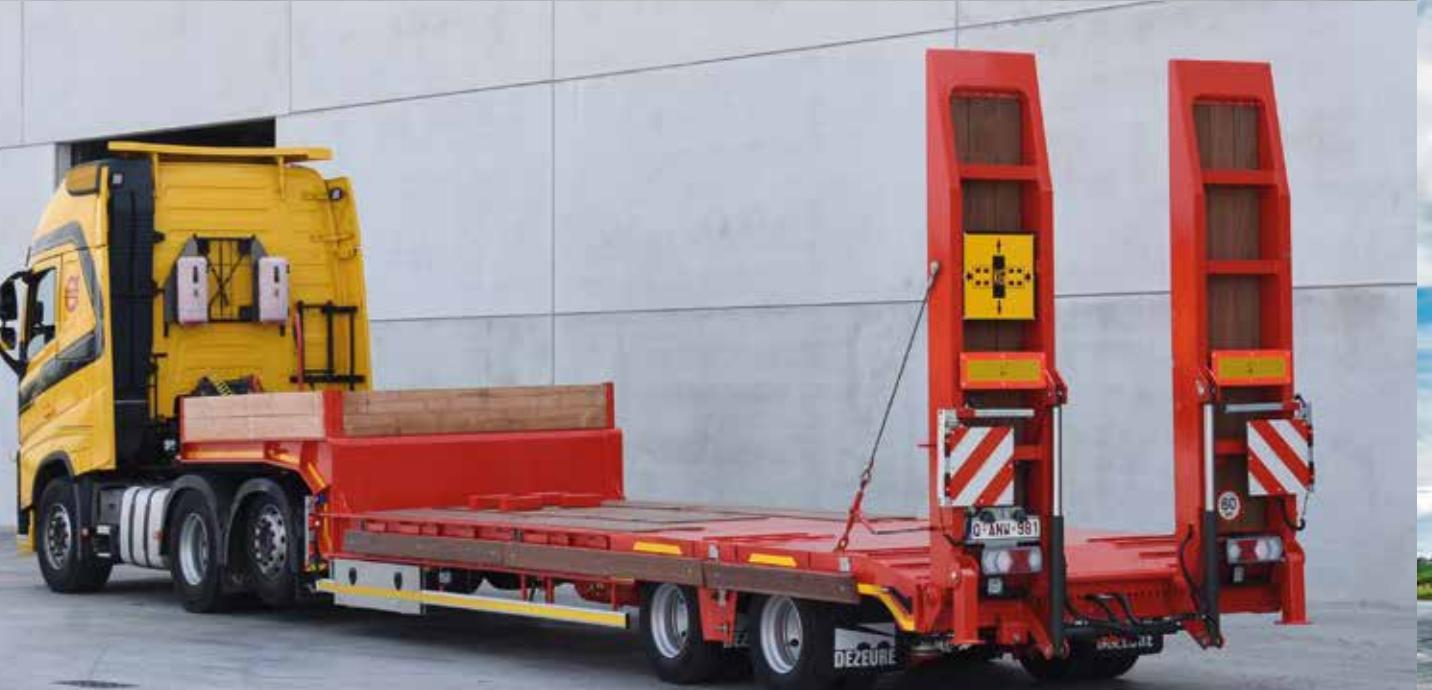
Ces remorques surbaissées sont fabriquées à partir de profils en **acier de haute qualité**. Ces profilés, combinés à une **précontrainte**, permettent de réduire le poids à vide sans sacrifier la **durabilité et la capacité de charge**. Comme nous fabriquons nous-mêmes les profilés, nous pouvons proposer les **dimensions idéales** en fonction des besoins du client. Les nombreuses possibilités d'options garantissent un champ d'application très large pour les remorques DEZEURE SRD.
